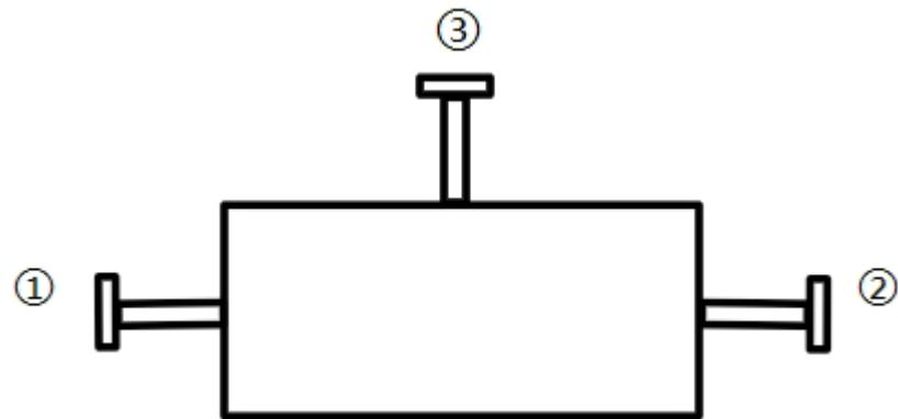
有三阀组校对：在设备运行时，先打开③，再关死①、②，长按Z键，直到归零；松开归零后，先关死③，再打开①、②，调零完成。
